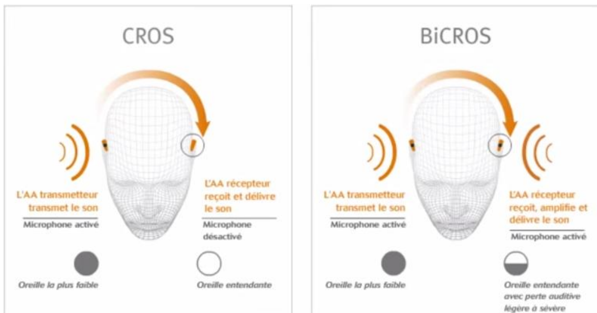
Figure 13 : Illustration du principe du CROS et du BiCROS [17]
