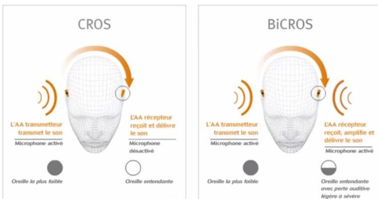
Figure 13 : Illustration du principe du CROS et du BiCROS <sup>[17]</sup>
