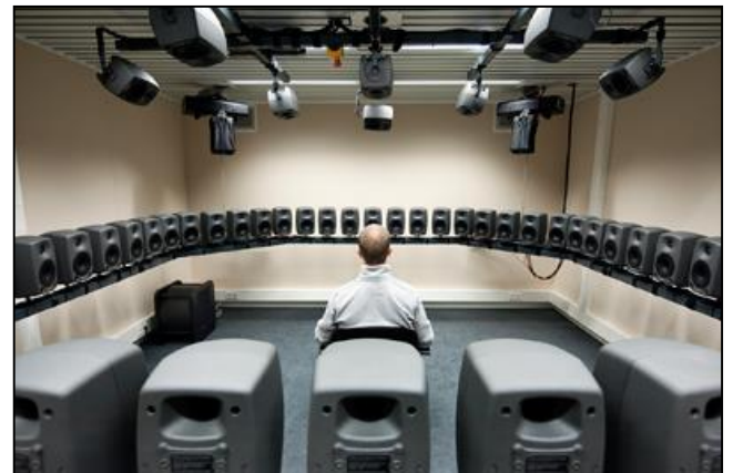
Figure 36 : Auditeur placé au centre du réseau de haut-parleurs holophonique de Sivantos (Siemens Audiologie) [100].
