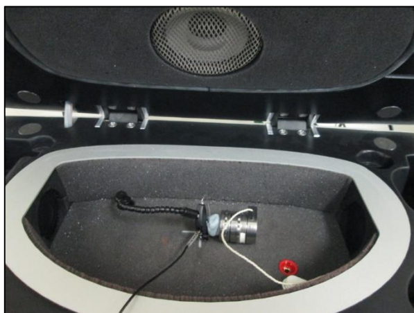
Figure 75 : Appareil placé dans le caisson de la chaîne de mesure Unity 2.
