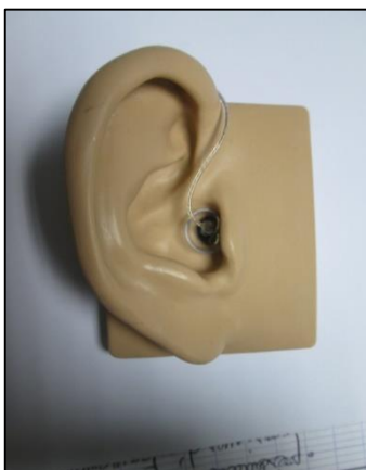
Figure 79 : écouteur inséré avec double dôme (vue externe)
