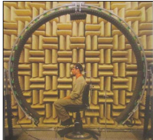
Figure 53 : Mesures des HRTF axe vertical [112].
