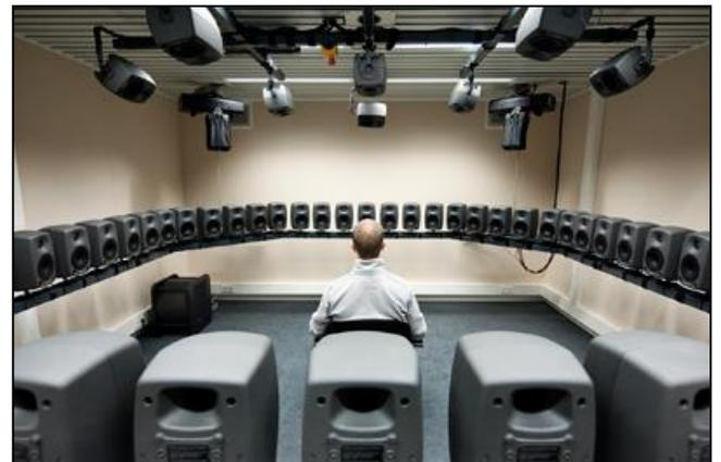
Figure 35 : Principe de l’holophonie (WFS) [99].
