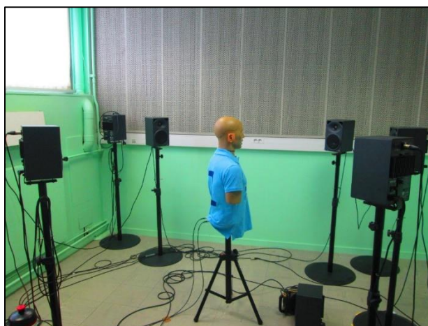
Figure 60 : Photographie de l'installation avec KEMAR face au HP central.
