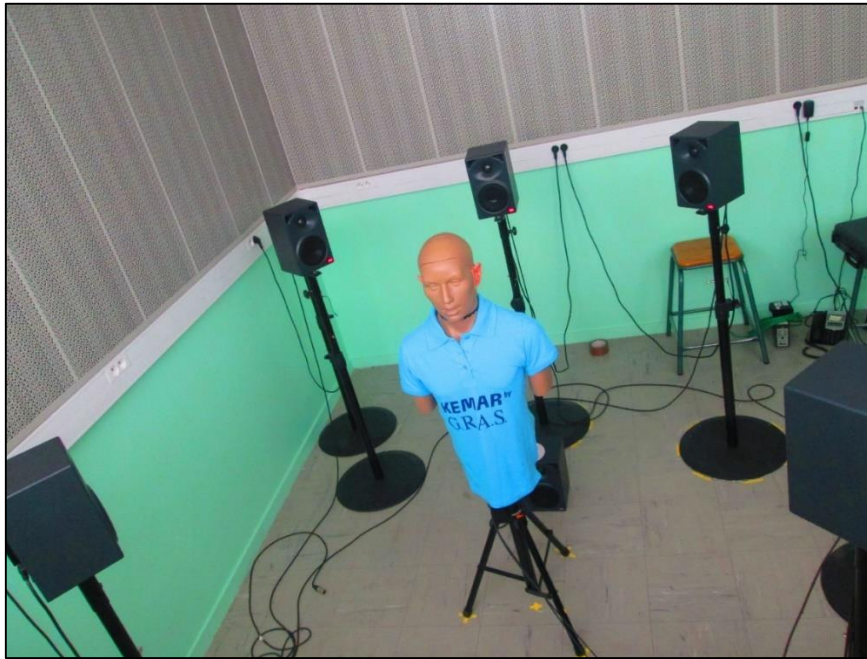
Figure 61 : Photographie de l'installation avec KEMAR dos au HP central (pour la photo).
