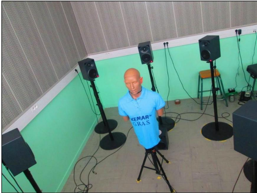
Figure 61 : Photographie de l'installation avec KEMAR dos au HP central (pour la photo).
