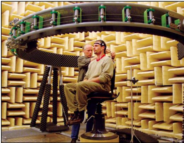
Figure 52 : Mesures des HRTF au centre de recherche néerlandais TNO [113].
