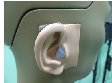
Figure 81 : appareil mis en place et ouverture du conduit artificiel obturé
