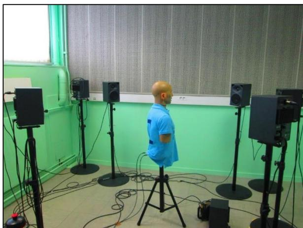
Figure 60 : Photographie de l'installation avec KEMAR face au HP central.
