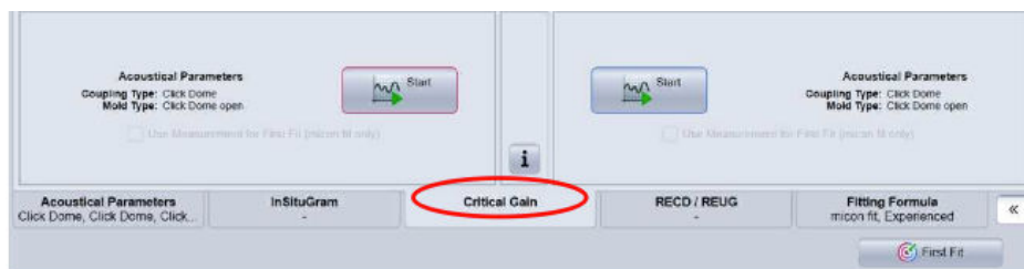
Figure 42 Troisième étape du pré réglage : le calibrage de l'anti-larsen
