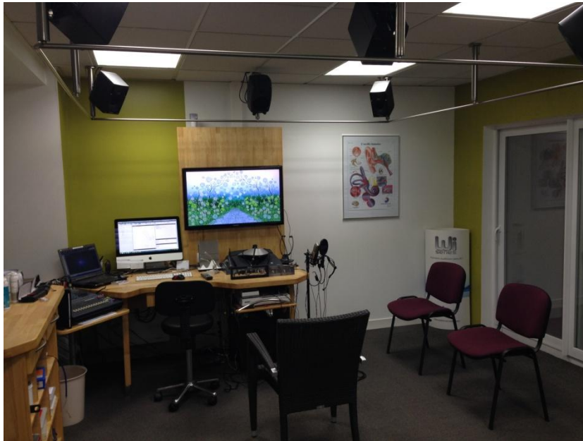
Figure 18 : Cabine d'examen avec système de haut-parleurs pour les mesures en champ libre
