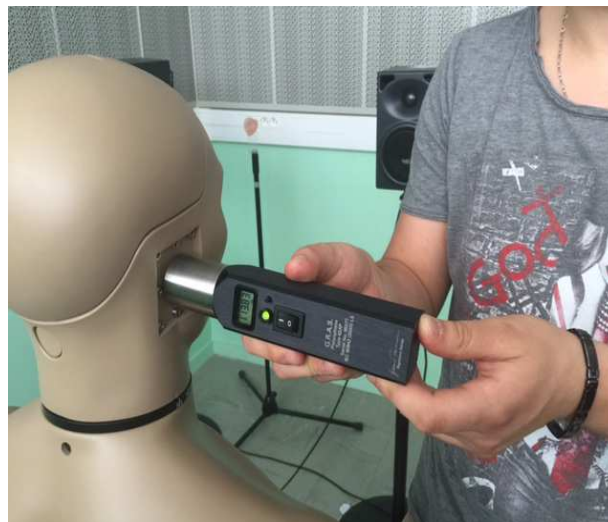
Figure 34 : étape d'étalonnage du KEMAR
