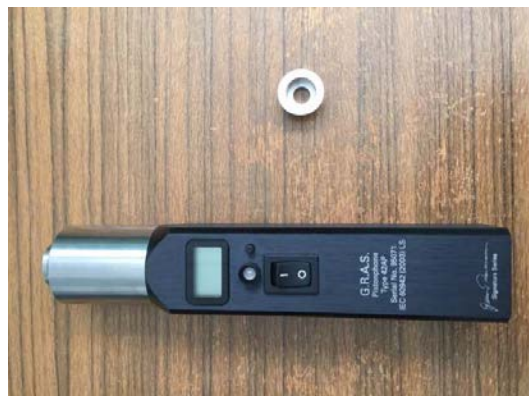
Figure 33 : piston-phone spécifique pour KEMAR et adaptateur
