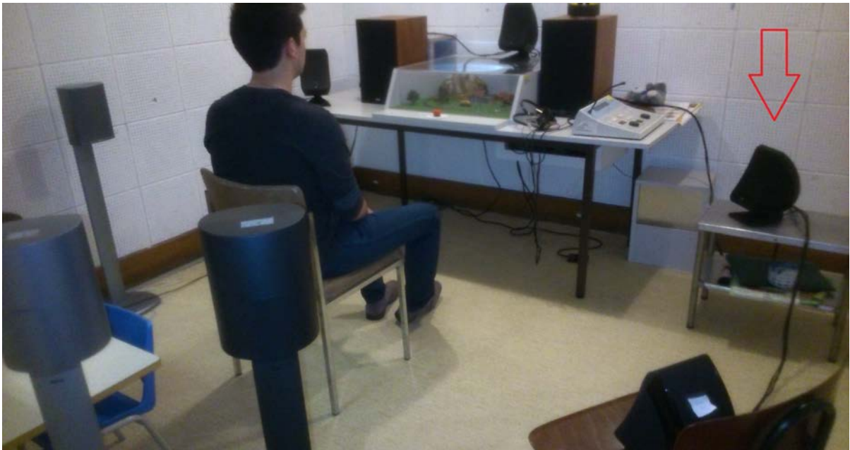
Figure 25 : disposition de la salle de mesure audiométrique
