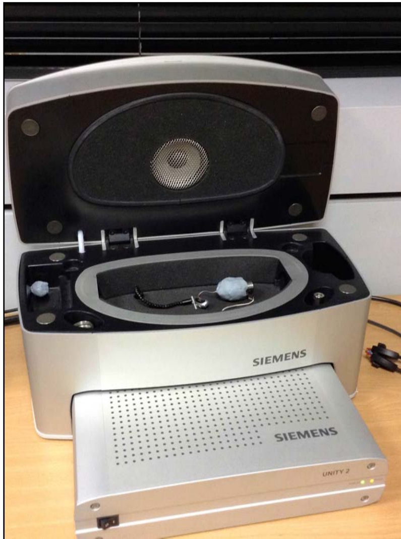
Figure n°18 : Réglage de l'appareil auditif Pure 7 Binax relié au coupleur 2cc de la chaîne de mesure Unity 2 de SIEMENS
