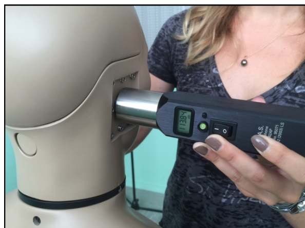
Figure n°14 : Calibration du coupleur de l'oreille droite du KEMAR
