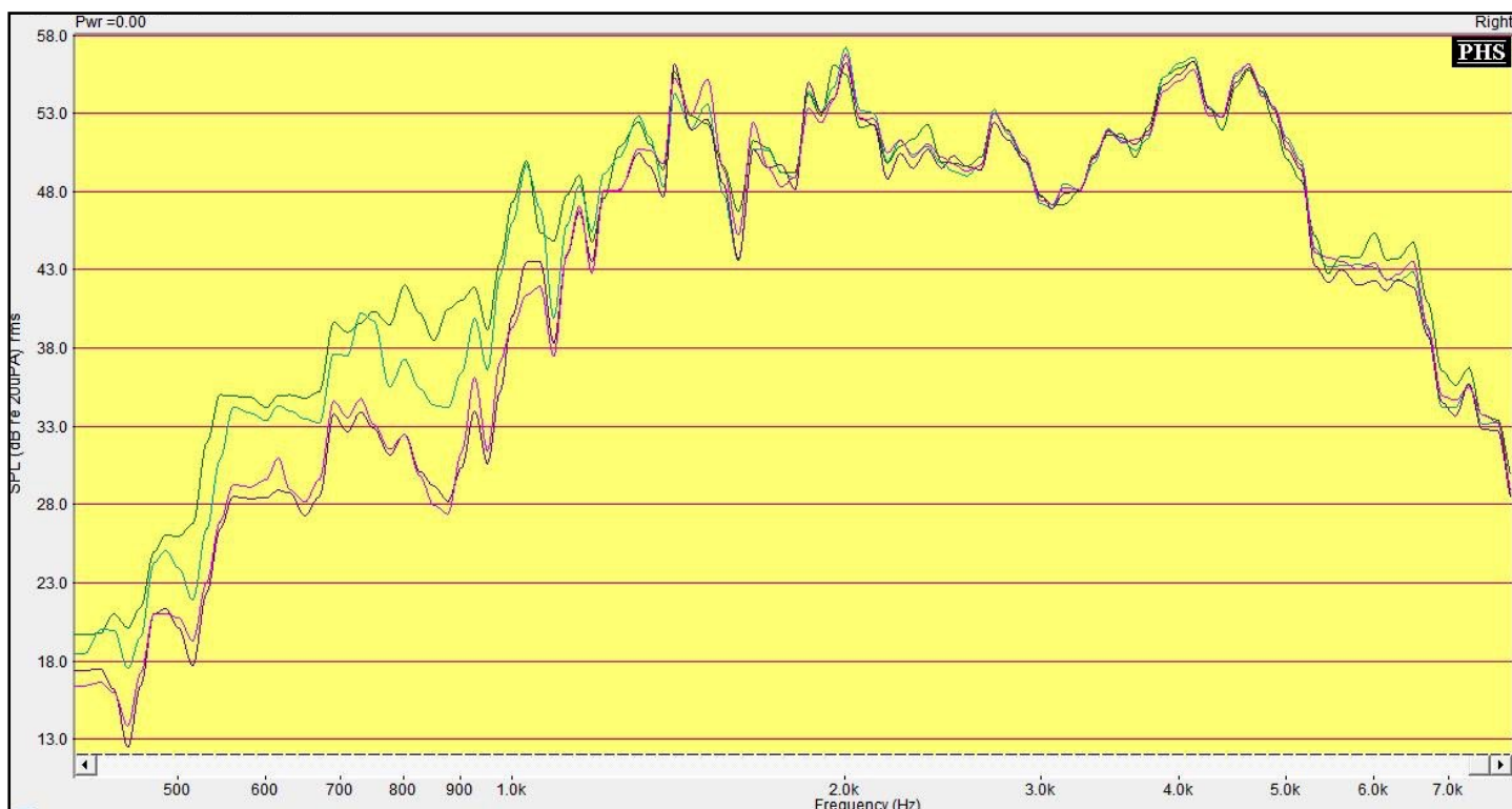
Figure n°62 : Spectres du bruit de salle de jeux d'enfants obtenus avec les programmes P1 (vert), en P2 (bleu), en P3 (violet) et en P4 (rose)
