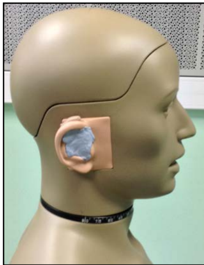
Figure n°15 : Disposition de l'appareil auditif sur l'oreille du KEMAR
