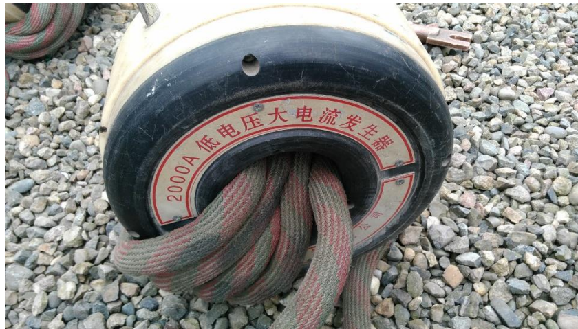
Deux bobines à basse tension et grand courant
