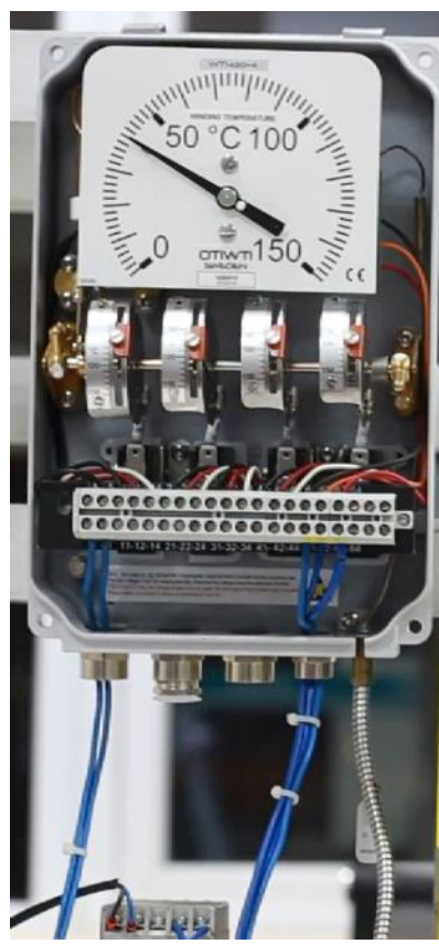
Intérieur du thermomètre
