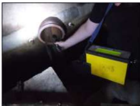
Figure 10 Capteur de vitesse en sortie du drain de la source
