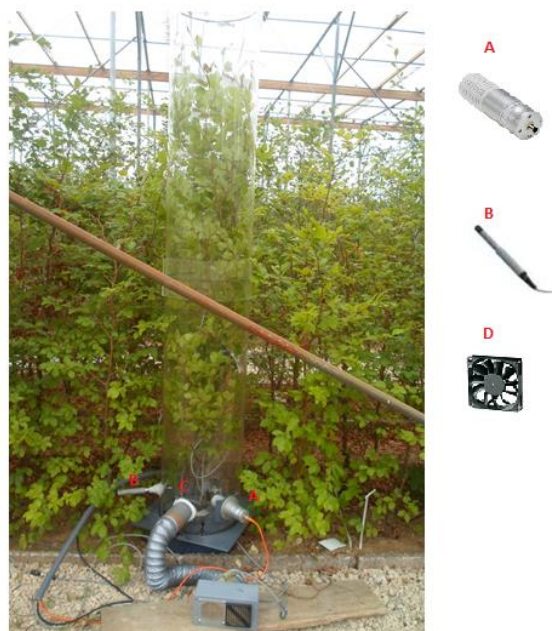
Figure 2- Chambre de mesure installée autour d'un arbre avec les éléments du système
