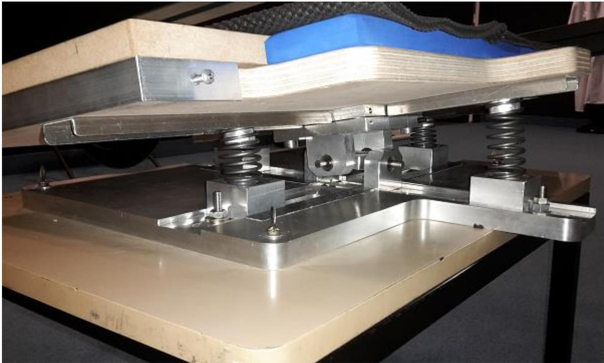
*Figure 6 : Système de double cardan entouré de 4 ressorts*
