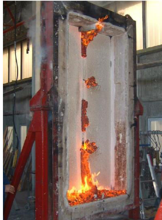
Figure 25 _ Poutre en LVL après 1 heure 23 minutes et 20 secondes d'allumage
