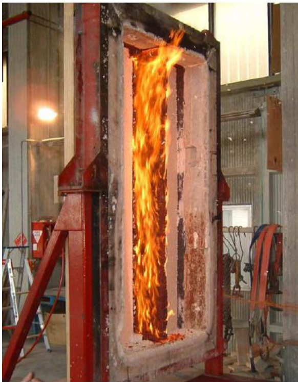
Figure 26 _ Poutre en LVL après 1 heure 00 minutes et 27 secondes d'allumage
