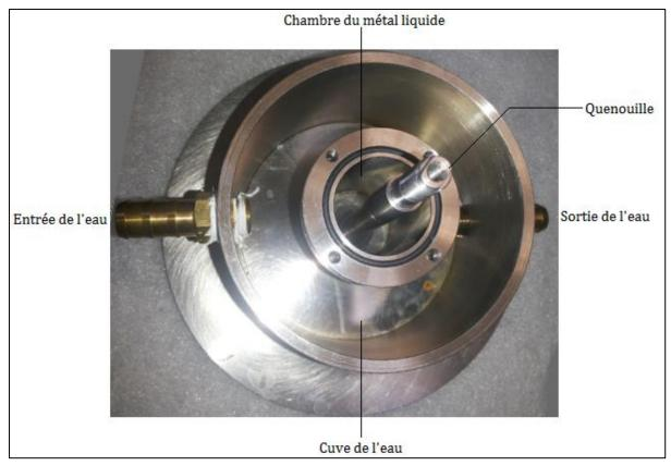
Figure 4.7. Générateur de gouttes de l'intérieur
