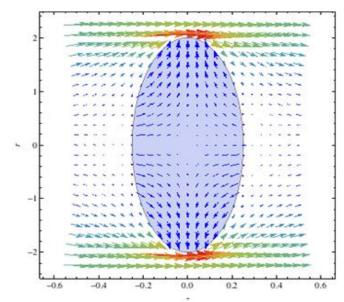
Figure 2.2. Ecoulement potentiel autour d'un sphéroïde aplati, et écoulement interne
