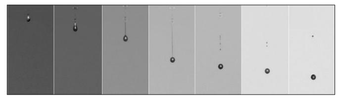
Figure4.11.Formation d'une goutte de Glycérine à 40 °C. La formation d'un film liquide après la goutte apparait
