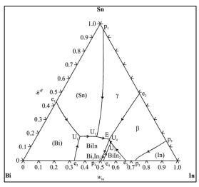
Figure 3.1. Diagramme eutectique Bi-In-Sn
