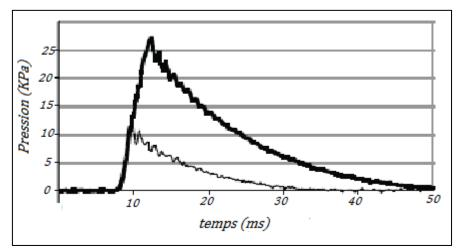
Figure 4.10. Variation de la pression dans le générateur pour le métal de Field à 70 °C pour  $t_{\rm in}$  = 10 ms et la pression d'alimentation P = 2.5 bars
