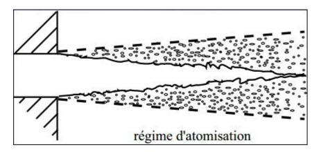
On distingue deux processus élémentaires du régime d'atomisation d'un jet liquide dans un fluide :
