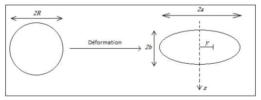
Figure 4.4. Déformation de la goutte sphérique
