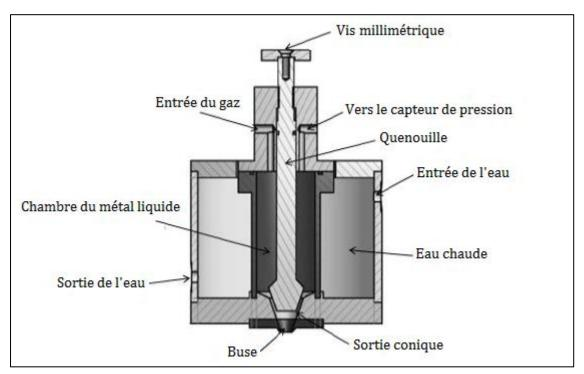
Figure 4.5. Schéma du générateur après modification
