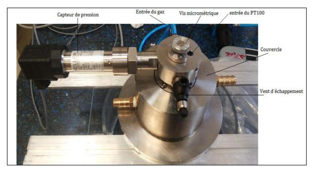
Figure 4.8. Générateur de gouttes de l'extérieur
