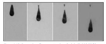
Figure 4.12. Formation d'une goutte de métal de Field à 80  $^{\circ}\text{C}$
