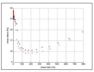
Figure 3.3. Variation de la contrainte de cisaillement en fonction du taux du cisaillement
