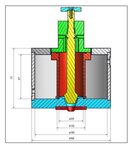
Figure 6.6. Dimensions (en mm) du générateur de gouttes
