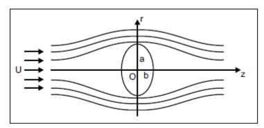
Figure 2.1. Ecoulement au-delà d'un sphéroïde
