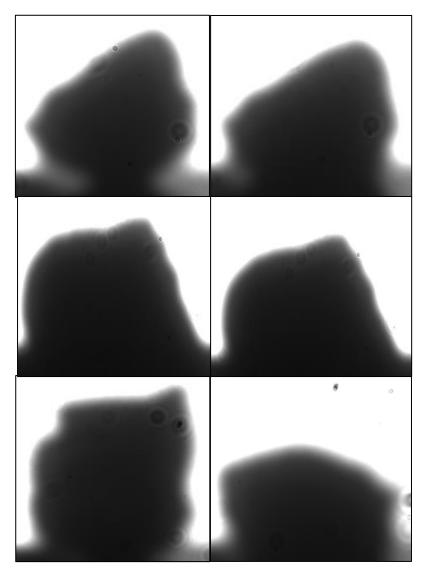
Figure 3.4. Différentes gouttes du métal de Field avant et après leur fusion
