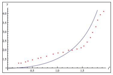
Figure 2.8. Variation de y avec le temps pour une goutte de l'eau dans l'air [10], U=14 m/s We=11.3, Oh=0.002, K=769.  $R_0=1.6$  mm. la ligne continue représente le résultat de l'équation 2.47, les points rouges sont data de [10]
