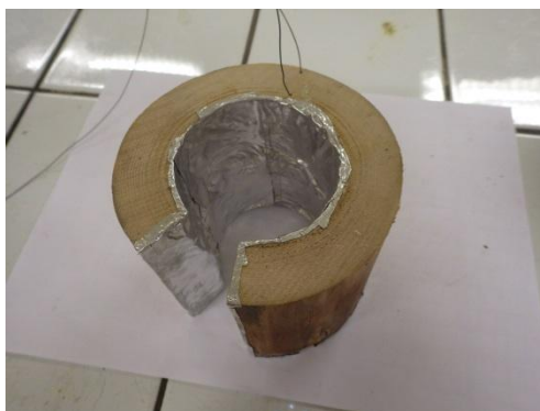
Figure 19 : photo du billon sans écorce dont une seule des extrémités longitudinales est recouverte de colle époxy et de papier aluminium ; thermocouples 104 et 105 visibles
