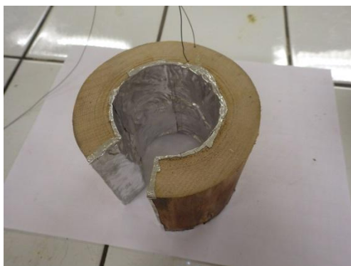
Figure 19 : photo du billon sans écorce dont une seule des extrémités longitudinales est recouverte de colle époxy et de papier aluminium ; thermocouples 104 et 105 visibles
