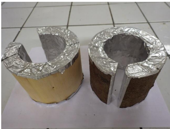
Figure 17 : photo des billons dont les deux extrémités longitudinales sont recouvertes de colle époxy et de papier aluminium
