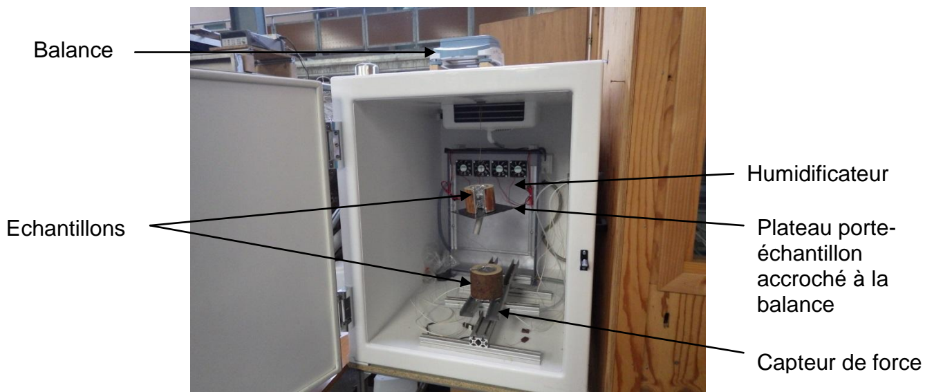
Figure 15 : photo de l'installation du matériel dans l'enceinte réfrigérante
