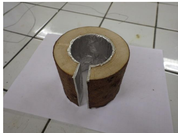
Figure 18 : photo du billon avec écorce dont une seule des extrémités longitudinales est recouverte de colle époxy et de papier aluminium ; face libre visible
