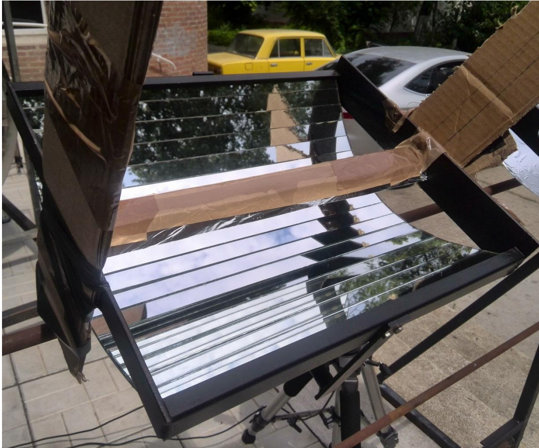
Photo de la coupe recouverte de miroirs de 2 cm de largeur (18 miroirs de 2 cm et 1 miroir de 1 cm pour compenser l'écartement et la place prise par la colle).
