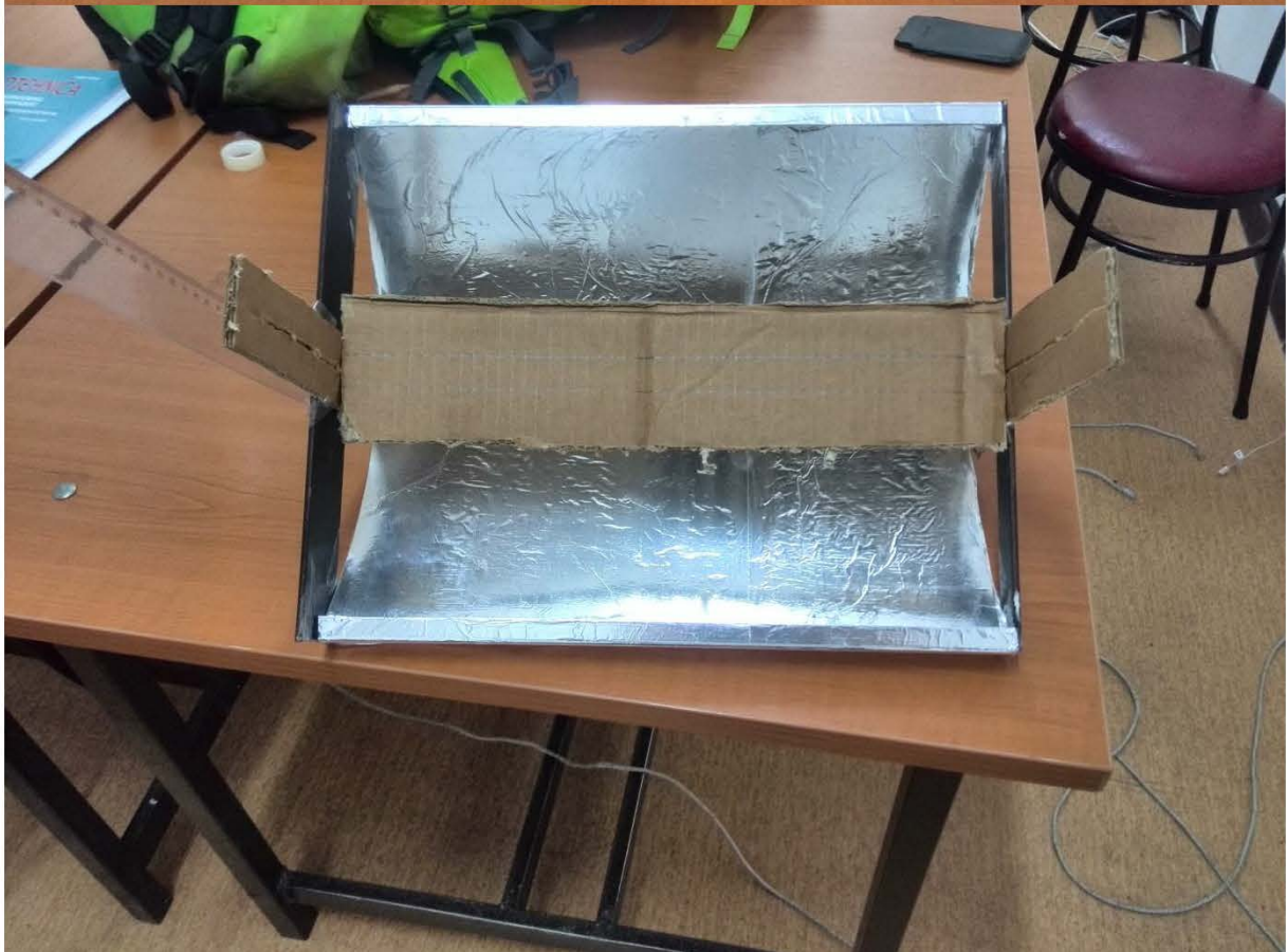
Photo de l'installation qui a servi à mesurer la distance focale sur les coupes recouvertes d'aluminium.
