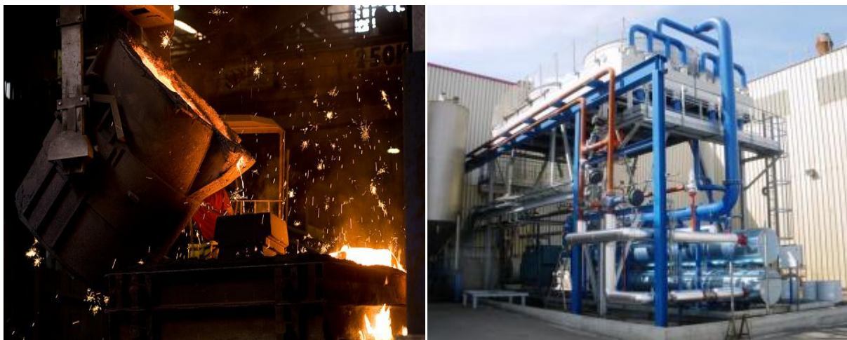
Photographie d'un four industriel a gauche et du système ORC couplé a droite(annexe 1 turboden).
