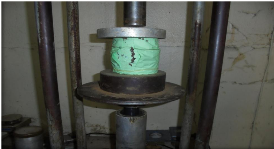
Figure 7 : Dispositif d'essai pour la compression simple
