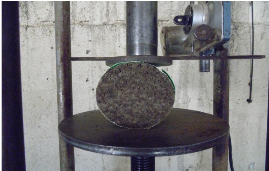
Figure 8 : Dispositif d'essai pour traction simple (essai brésilien)
