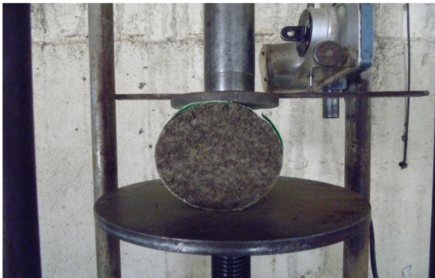
Figure 8 : Dispositif d'essai pour traction simple (essai brésilien)
