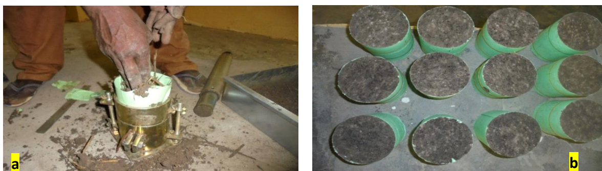
Figure 6 : Préparations des éprouvettes (a), éprouvettes fabriquées et mises au séchage (b)
