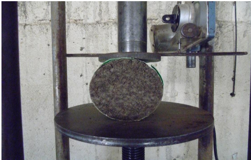
Figure 8 : Dispositif d'essai pour traction simple (essai brésilien)
