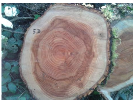
Figure 3 : Rondelle de bois altérée et colorée (Photo L. Laget)
