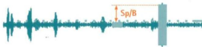
Figure 23 : Comportement du réducteur de bruit Phonak sur 2 bandes de fréquence [35]
