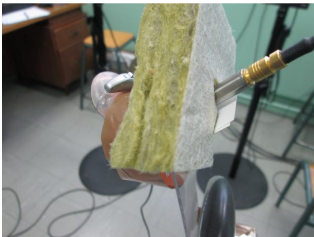
Figure 42 : Disposition de l'oreille en silicone et système d'acquisition Symphonie
