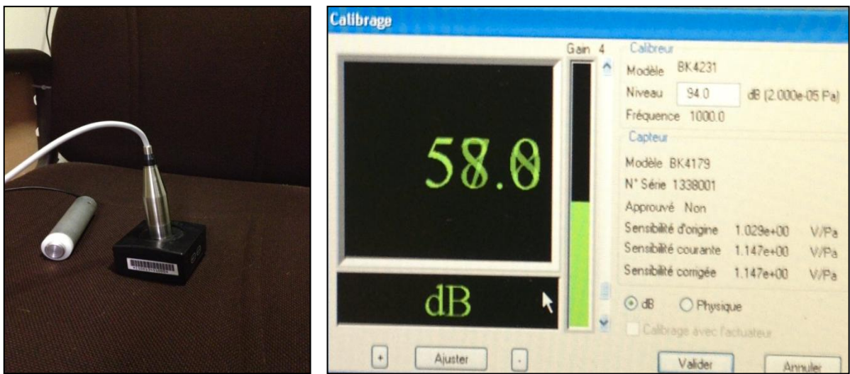
Figure 17: Calibrage du microphone faible bruit B&K de type 4179
