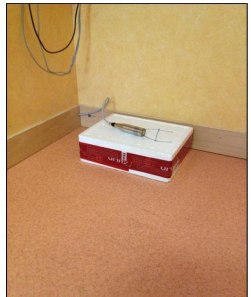
Figure 48: Microphone faible bruit positionné sur un support (fragilité de ce type de microphone)
