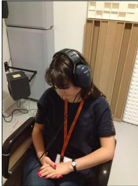
Figure 24: Casque TDH 39 équipé de coques PELTOR
