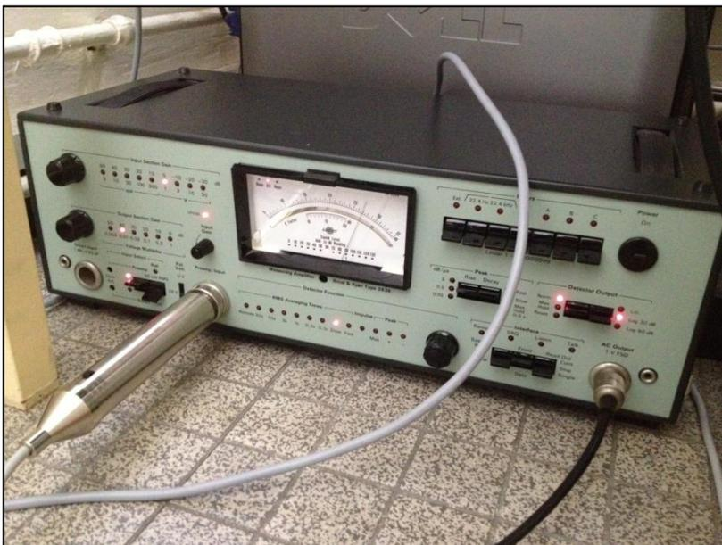
Figure 47: Amplificateur de mesure B&K de type 2636 réglé avec un gain de 40 dB sur la section de sortie (Output Section Gain)
