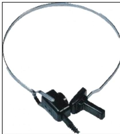
Figure 27: Ossivibrateur de type B71
