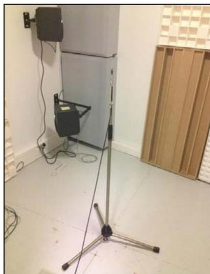
*Figure 31: Microphone de référence positionné sur un pied*
