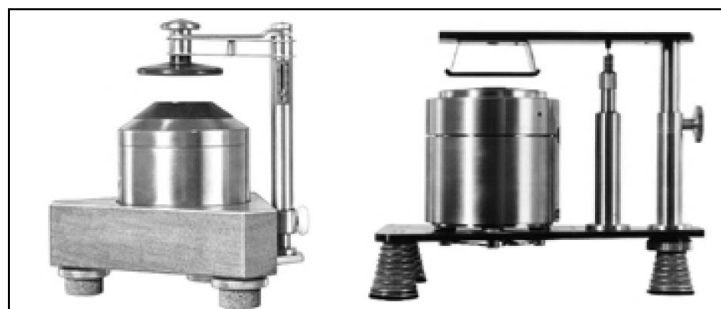
Figure 22: Oreille artificielle et mastoïde artificielle
