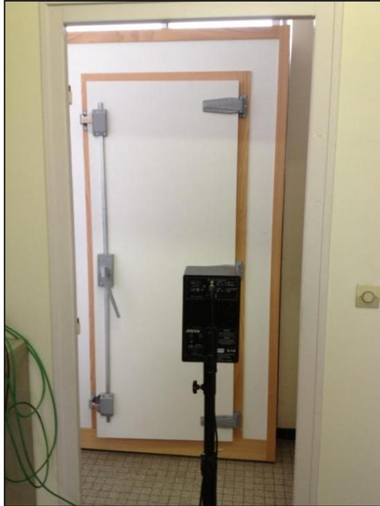
*Figure 56: Haut-parleur positionné face à une paroi de la cabine standard*
