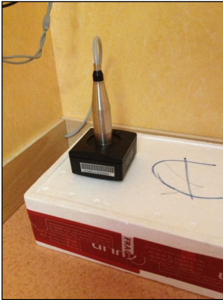
Figure 46: Calibrage du microphone faible bruit B&K de type 4179
