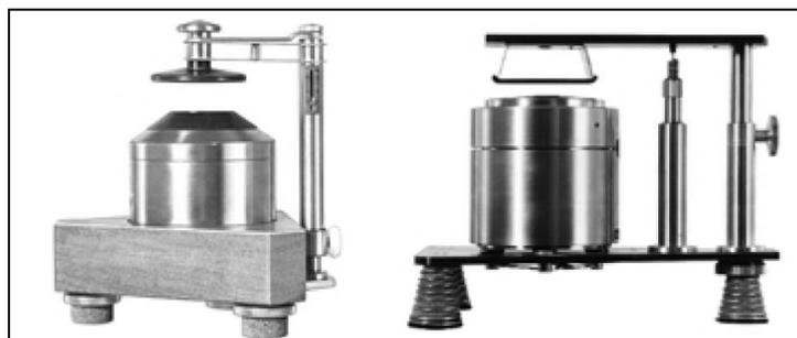
*Figure 22: Oreille artificielle et mastoïde artificielle*
