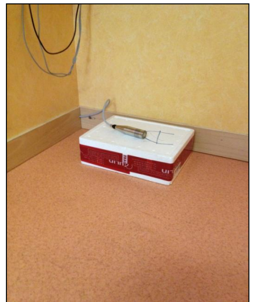
Figure 48: Microphone faible bruit positionné sur un support (fragilité de ce type de microphone)
