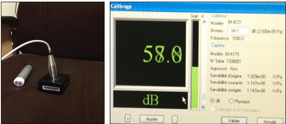
Figure 17: Calibrage du microphone faible bruit B&K de type 4179
