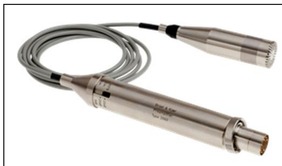
Figure 14: Microphone faible bruit B&K de type 4179 associé à son préamplificateur B&K de type 2660
