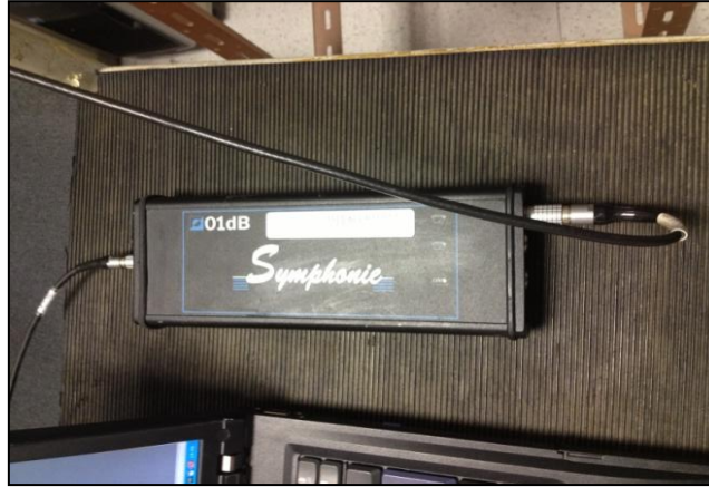
Figure 21: Système d'acquisition bi-voies Symphonie de 01 dB-METRABIB
