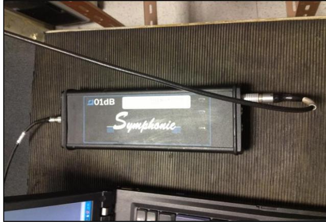
*Figure 21: Système d'acquisition bi-voies Symphonie de 01 dB-METRABIB*
