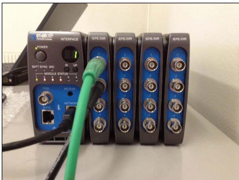
Figure 37: Système d'acquisition 16 voies Orchestra de 01 dB-METRAVIB
