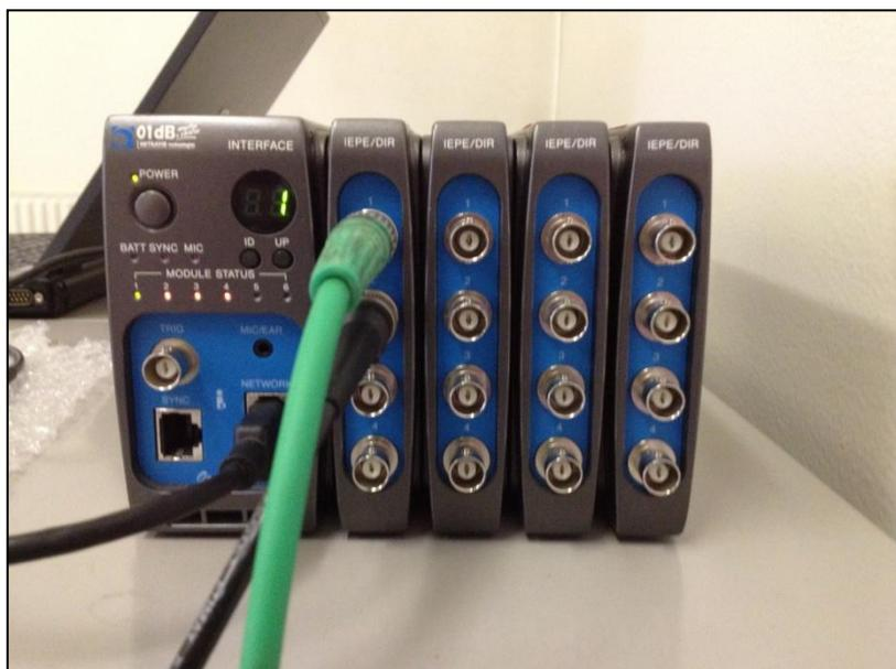
Figure 37: Système d'acquisition 16 voies Orchestra de 01 dB-METRAVIB
