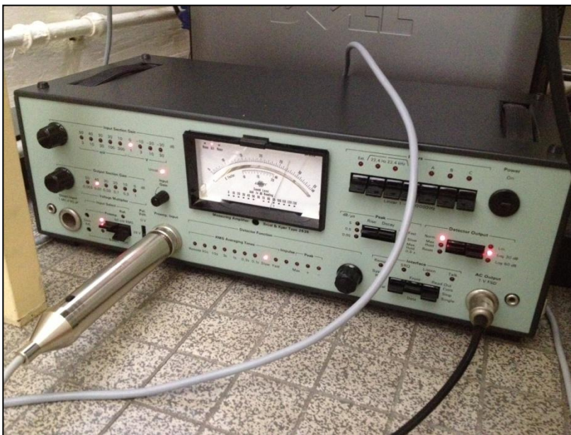
Figure 47: Amplificateur de mesure B&K de type 2636 réglé avec un gain de 40 dB sur la section de sortie (Output Section Gain)
