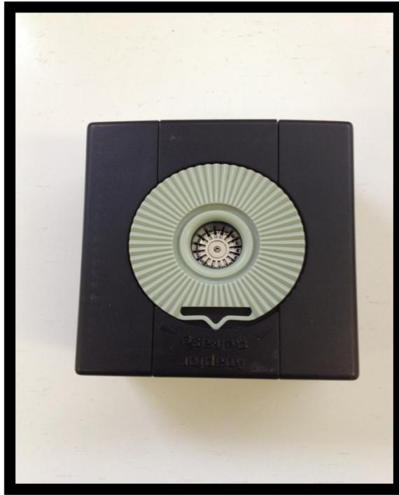
Figure 19 : Piston-phone émettant un son pure à 94 dB
