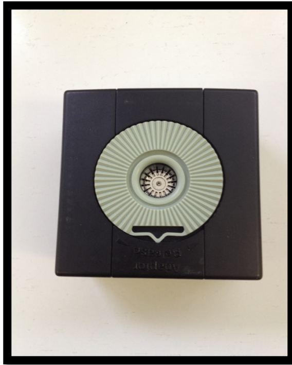
Figure 19 : Piston-phone émettant un son pure à 94 dB
