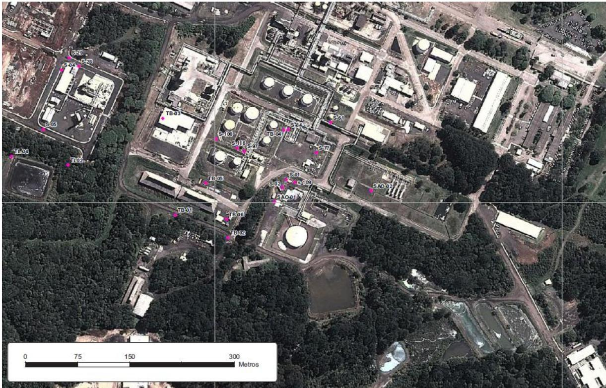
**Figure 6 - Localisation des sondages contaminés par des hydrocarbures.**
