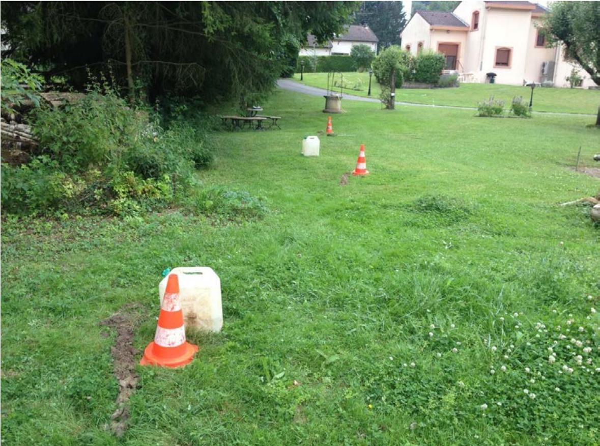
**Photo 3** Vue d'ensemble du test de perméabilité réalisé sur l'un des trois trous de tarière.
