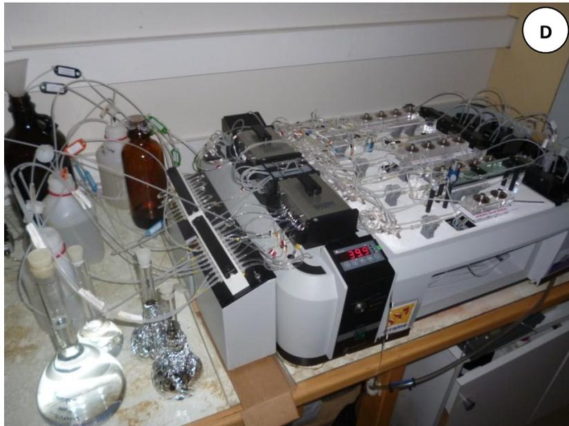
**D** - La teneur en ammonium ( $\text{NH}_4^+$ ) est mesurée par colorimétrie à flux continu (spectromètre d'absorption moléculaire San<sup>++</sup> de SKALAR). Le spectromètre est constitué d'une source lumineuse, d'un système dispersif (monochromateur) et d'un détecteur. Le principe est basé sur l'absorption des radiations lumineuses par l'ammonium présent dans l'échantillon.
