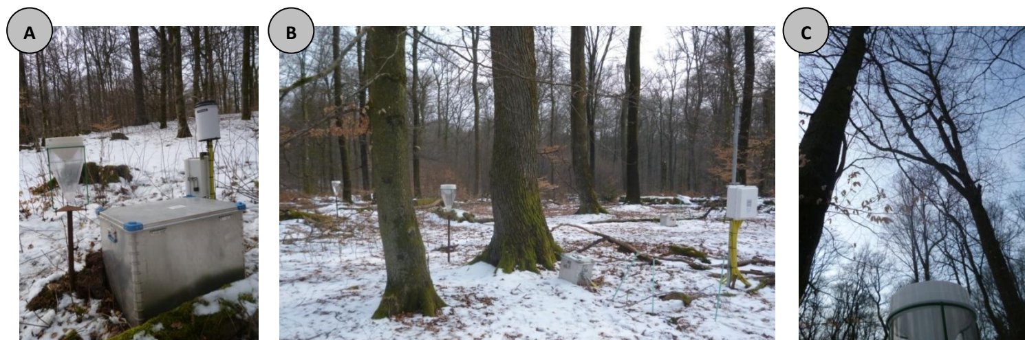
Figure 9 – Photos du dispositif hors sol de la placette expérimentale du Weierbach : pluviomètre collectant les précipitations (A) et entonnoirs collectant les pluiolessivats (B et C).
