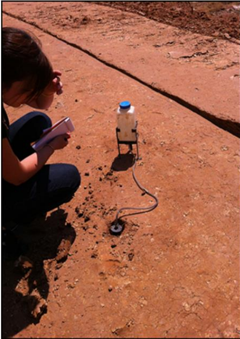
Sur le terrain : mesure du volume d'eau écoulé grâce au bidon, en fonction du temps
