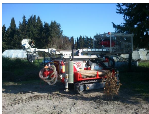
Figure 17 : Photographies de la foreuse (EGSA btp) et de la sonde piézométrique
