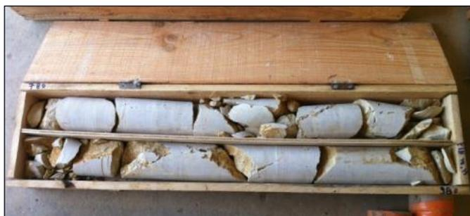
**Figure 15** : Photographie d'une carotte de calcaire
