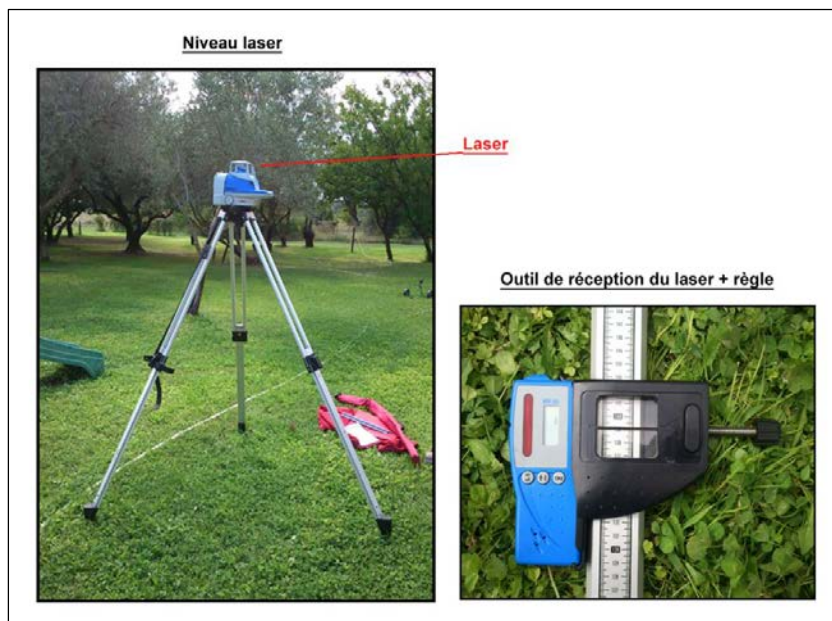
Figure 9 : Photographies du niveau laser sur pied et de l'outil bipant lors de la réception du laser
