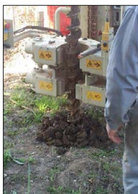
Figure 17 : Photographies de la foreuse (EGSA btp) et de la sonde piézométrique
