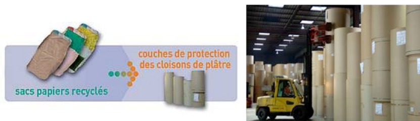
Figure 18 : Photographie des rouleaux de papier de protection des cloisons en plâtre destinés au bâtiment.
