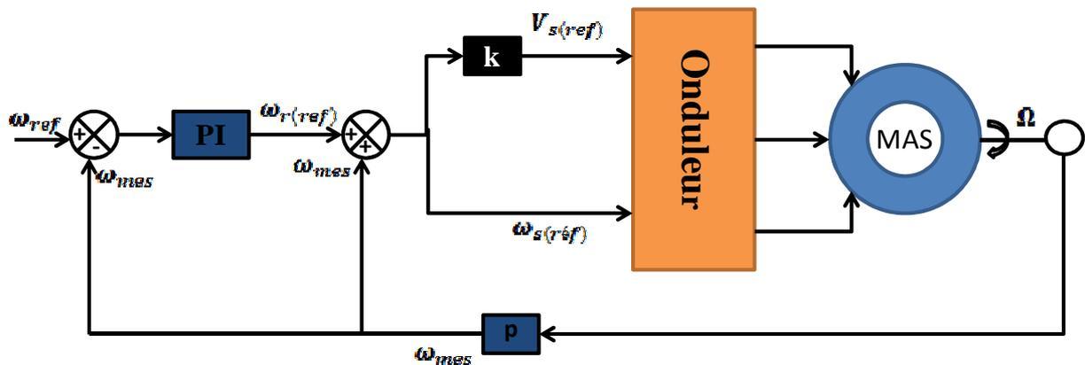
Figure 11: Principe de la commande à flux constant
