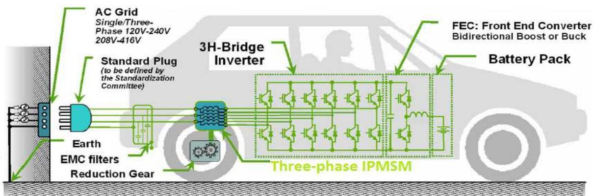
Figure 2: Topologie de l'actionneur SOFRACI [4]
