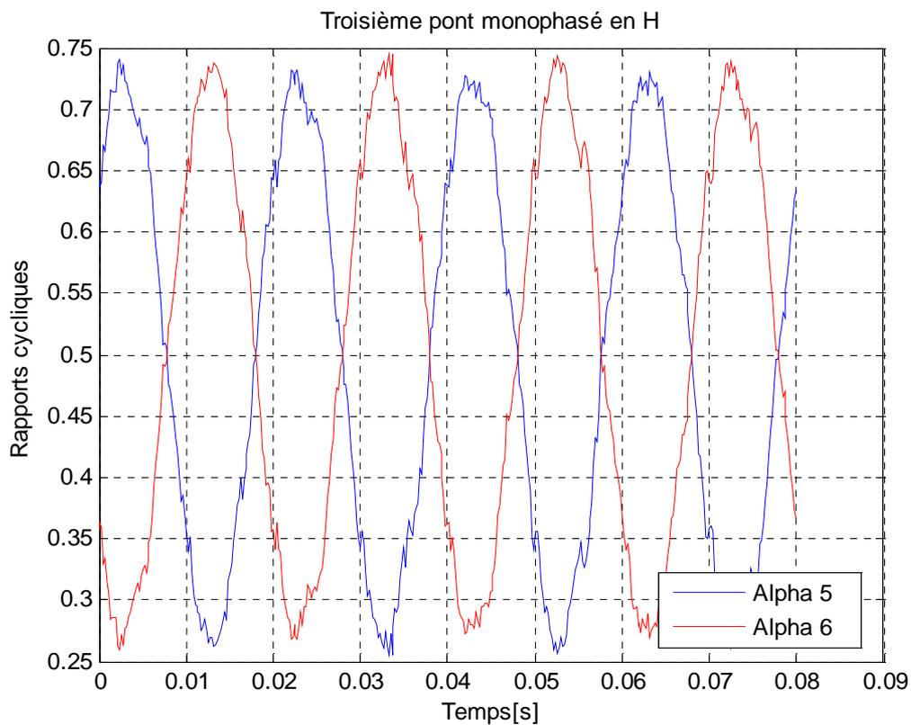
Figure 25 : Rapports cycliques des deux IGBT supérieurs du troisième pont en H
