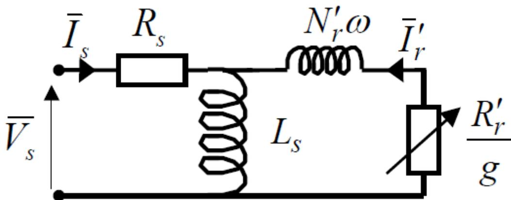
Figure 10: Schéma équivalent de la machine asynchrone
