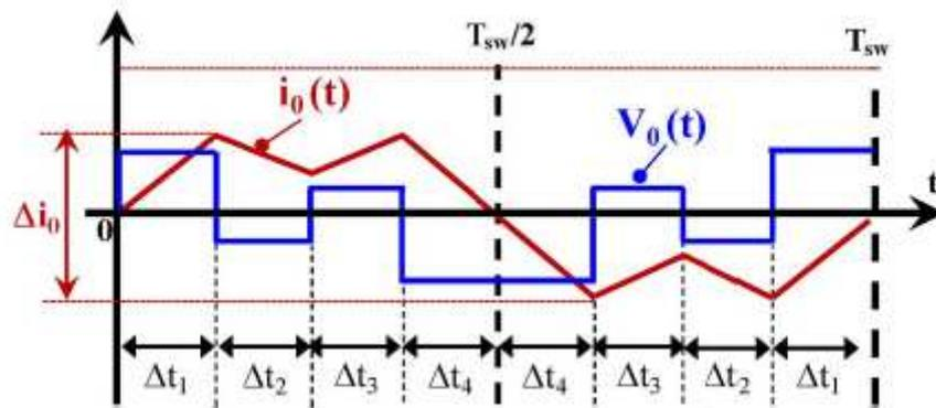
Figure 9 : allures de la tension et du courant homopolaire sur une période de découpage
