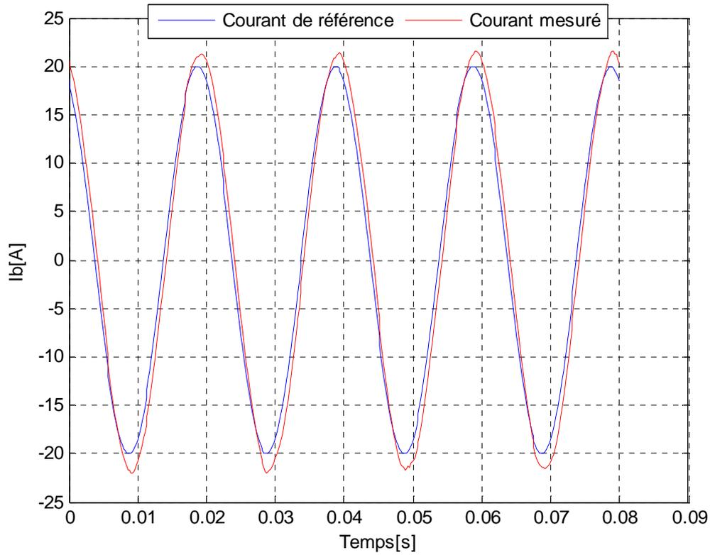
Figure 21 : Réponse en courant de la phase « b »
