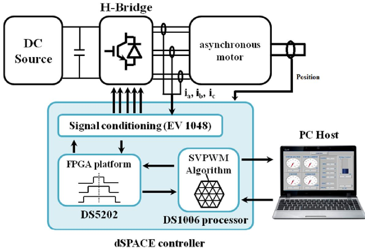
Figure 18 : Schéma de principe du banc d'essais
