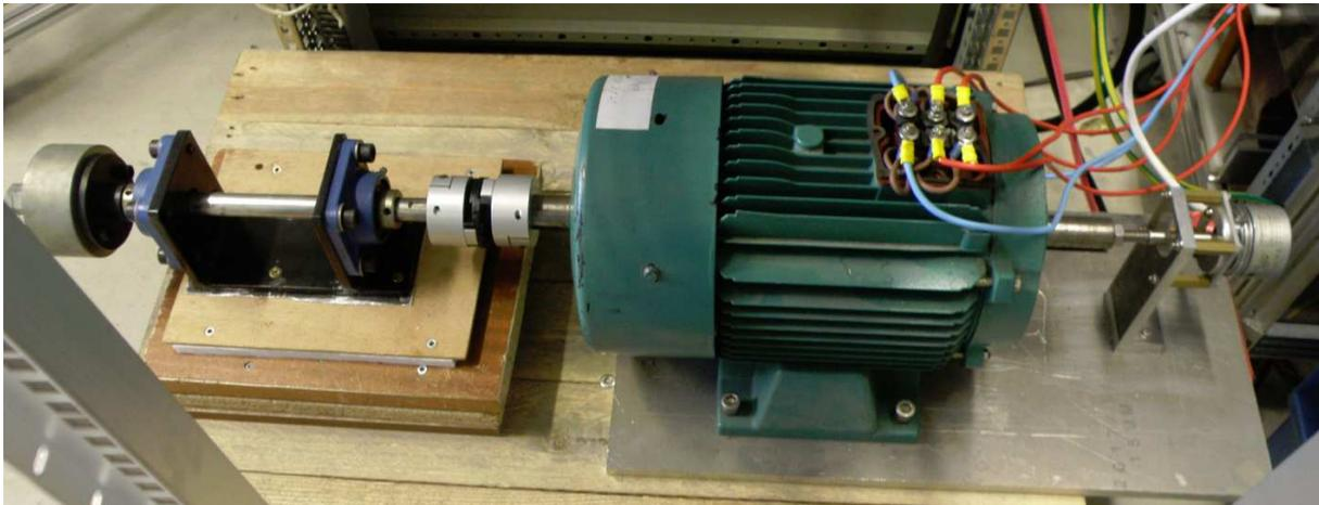
Figure 14 : Banc de l'ensemble moteur asynchrone-codeur incrémental-accouplement-charge
