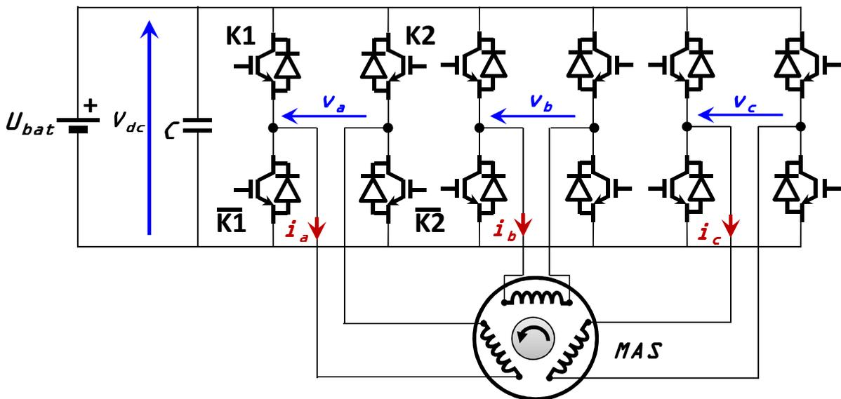
Figure 4: structure d'un onduleur en trois ponts H
