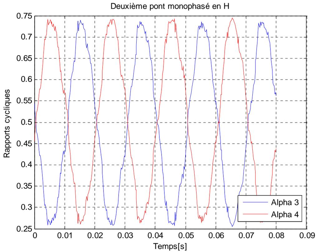
Figure 24 : Rapports cycliques des deux IGBT supérieurs du deuxième pont en H
