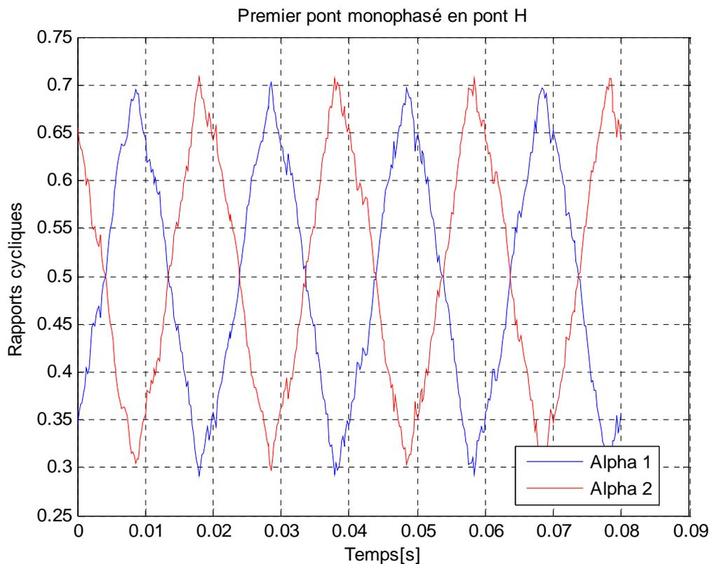
Figure 23: Rapports cycliques des deux IGBT supérieurs du premier pont en H
