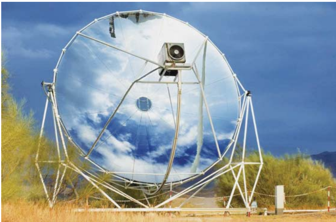
Figure 3-5 : Capteur parabolique avec moteur de Stirling. DLR/Markus Steur
