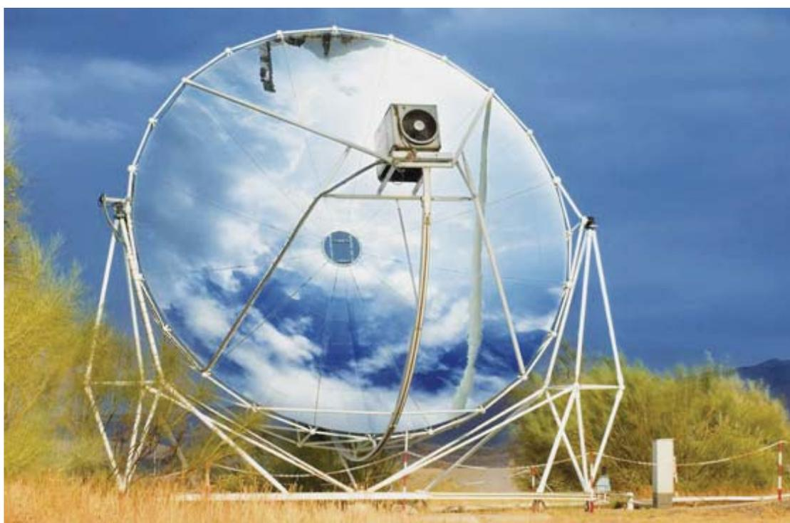
Figure 3-5 : Capteur parabolique avec moteur de Stirling.
