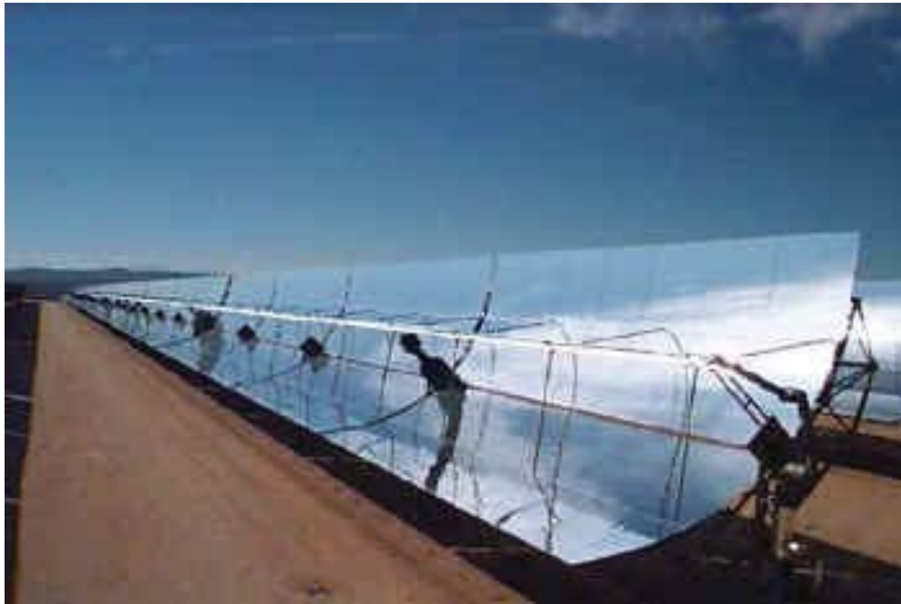
Figure 3-3 : Collecteur cylindro-parabolique de la centrale de Kramer Junction, en Californie.
