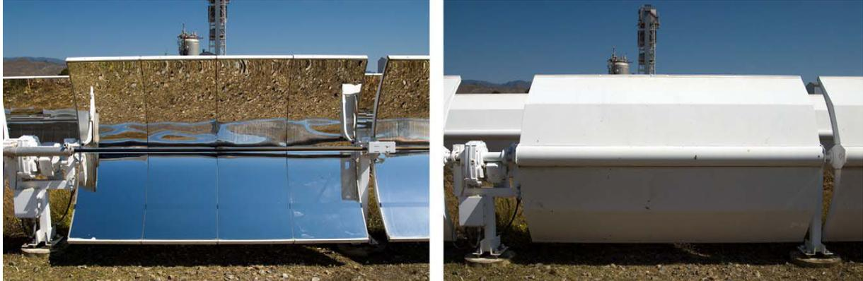
Figure 9 Miroir cylindro-paraboliques [23]
