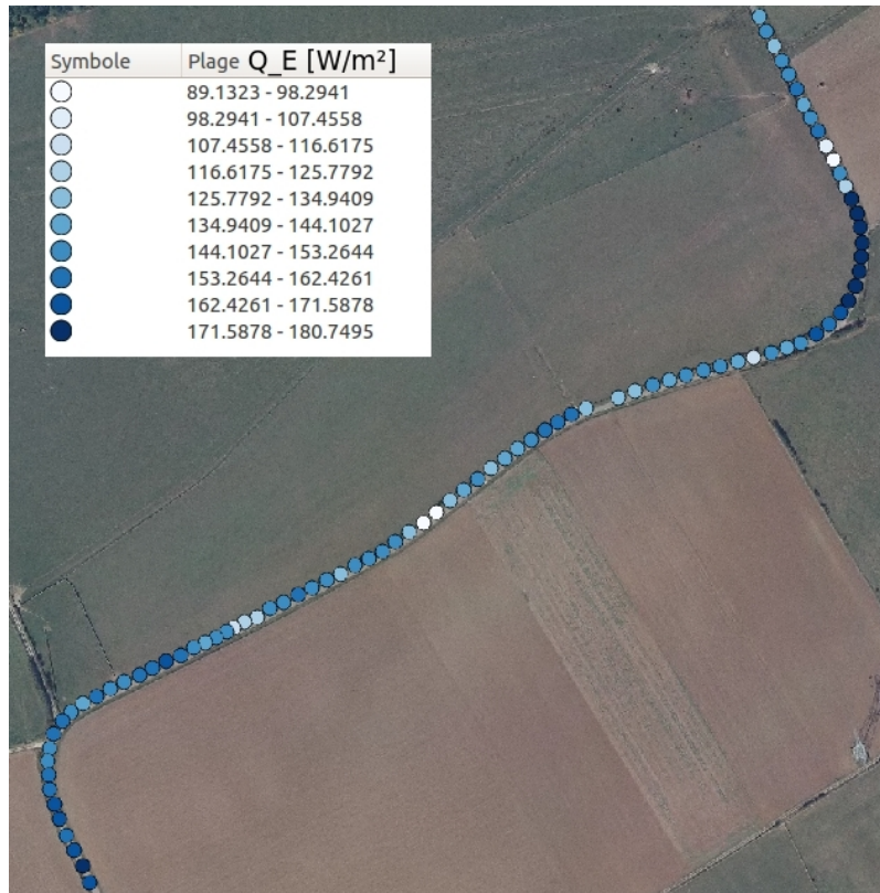
FIGURE 3.6 – Représentation visuelle de la variation de Q_E , selon les points de mesure (procédure (1)), sur une carte de la zone d'étude. Mesures du 08/07/13 à Cerville.
