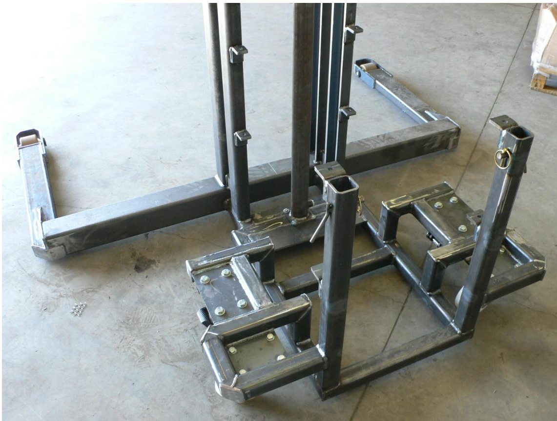
Bâti après installation du vérin de levage
