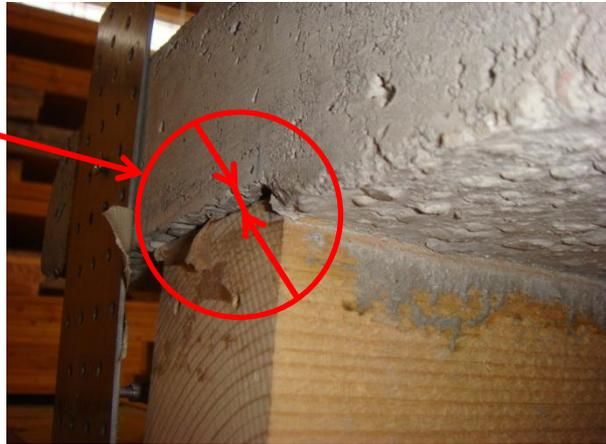
*Photo 24 : Déplacement relatif à la rupture*
