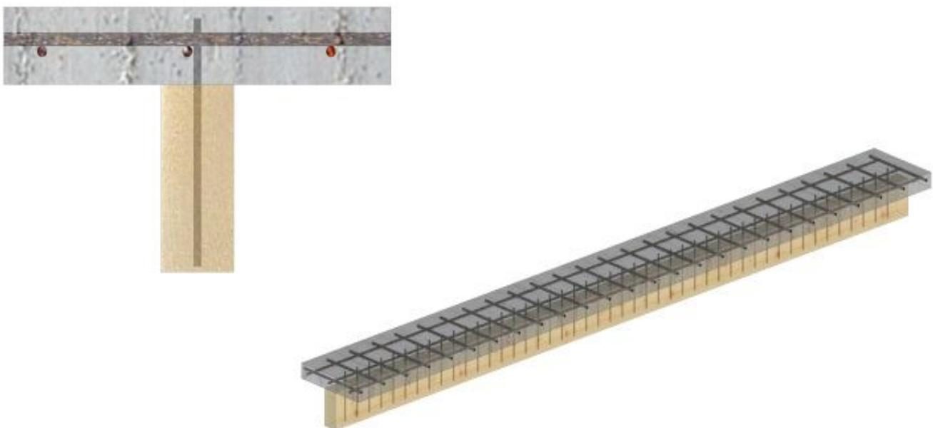
*Figure 17 : Dessin Cadwork de la poutre bois/béton*
