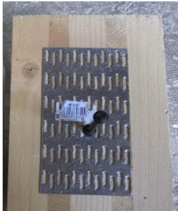
*Photo 13 : Eprouvette renforcé par plaques dentées*
