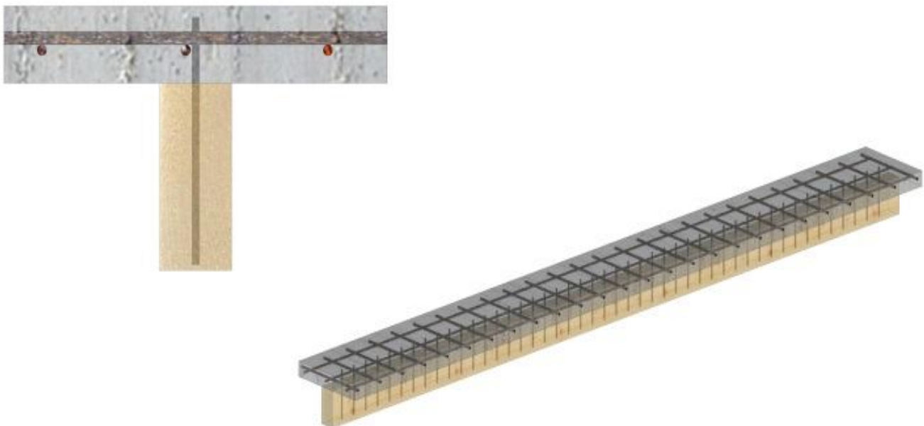
Figure 17 : Dessin Cadwork de la poutre bois/béton
