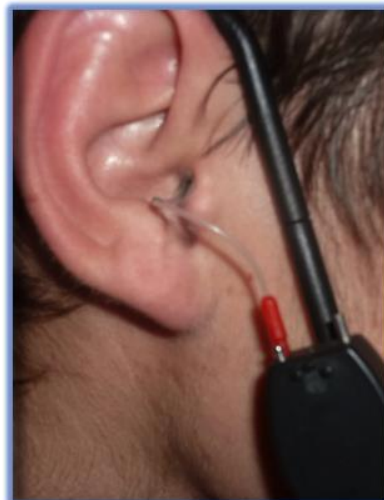
Fig 29 : Placement de la sonde in vivo dans le CAE
