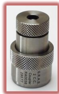
Fig 5 : Coupleur 2cc normalisé IEC 126 et ANSI S3.7-1973 7
