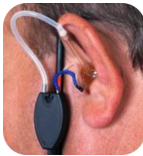
Fig 15 : Mesure du RECD par l'embout du patient extrait du blog de l'audioprothésiste.
