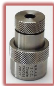
Fig 5 : Coupleur 2cc normalisé IEC 126 et ANSI S3.7-1973 7
