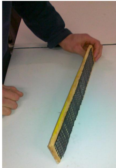
Figure 15 : Section hors norme renforcée
