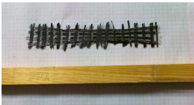
Figure 22: Illustration de la rupture du CFRP au niveau du joint de colle
