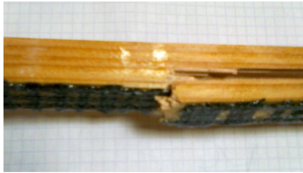
Figure 14 : Illustration du cisaillement dans l'éprouvette
