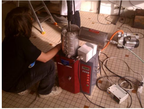
Figure 30 : Installation de l'ELPI
