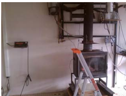
Figure 28: Foyer fermé avec l'indicateur de masse à gauche
