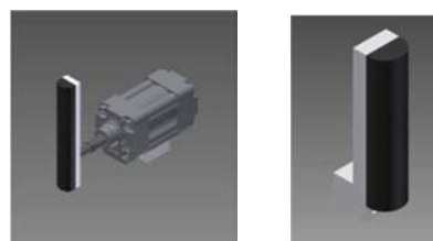
Figure 37 : Vérins et appuis pour maintien des pièces et des avivés
