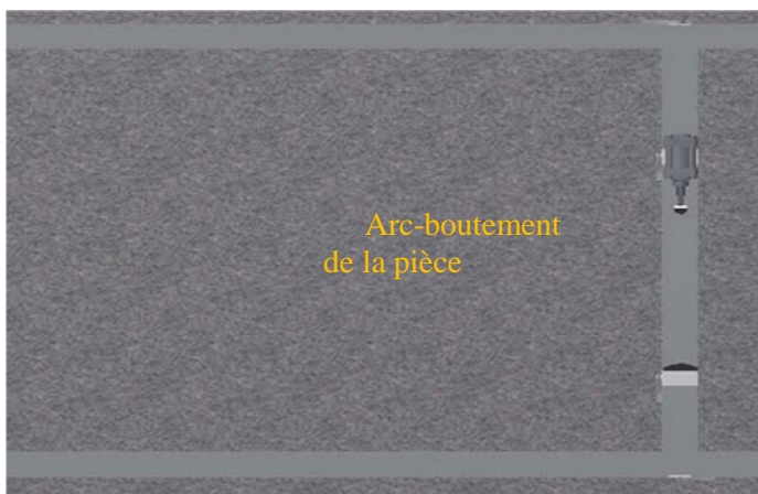
Figure 39: Représentation du risque d'avancer de manière non parallèle des deux côtés de la glissière
