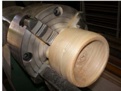
Figure 24 : Mandrin de serrage pour tour à bois
