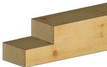
Figure 12 : Tenonnage par sciage d'un assemblage par mi-bois
