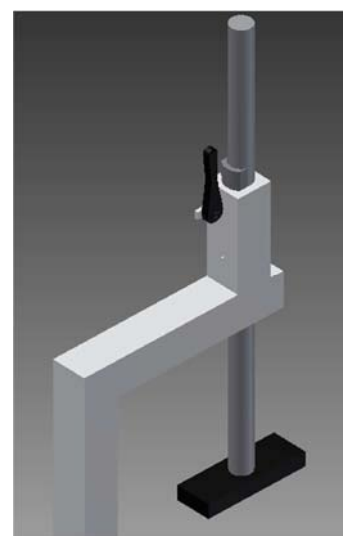
Figure 53 Pince de serrage en liaison glissière
