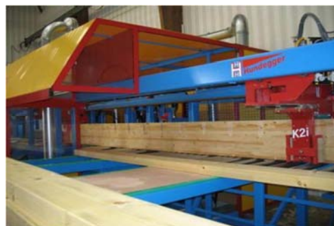
Figure 17: Centre d'usinage de type K2
