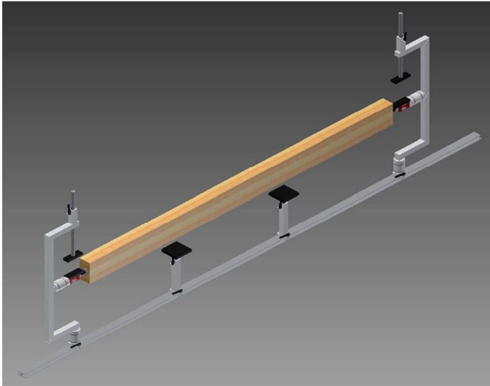
Figure 49 Visuel de la solution de maintien des pièces
