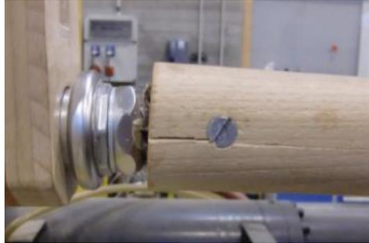
*Figure 43 : Fissure apparue lors du troisième essai*
