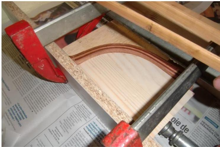
*Figure 32: Montage d'usinage pour le ceintrage du frein*
