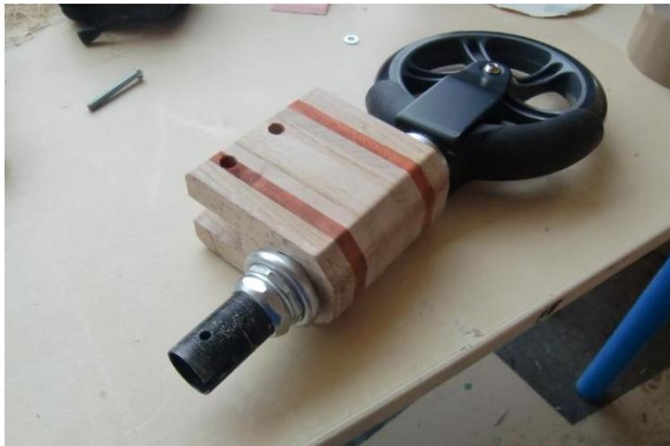
*Figure 29: Tube de direction et fourche*
