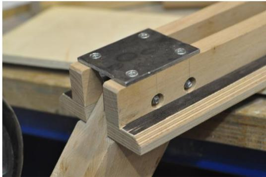
*Figure 35 : Mise en place de l'âme métallique entre la plateforme et le lien*
