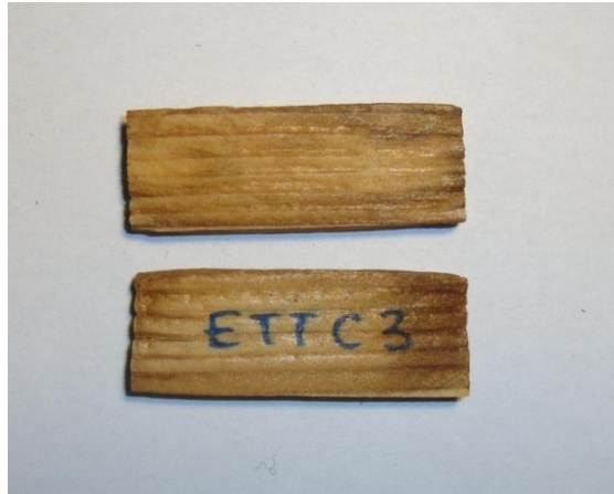
Figure 19 : Dégradation d'un échantillon témoin
