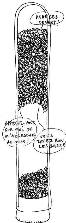
Figure 11: Illustration de l'effet de voûte
