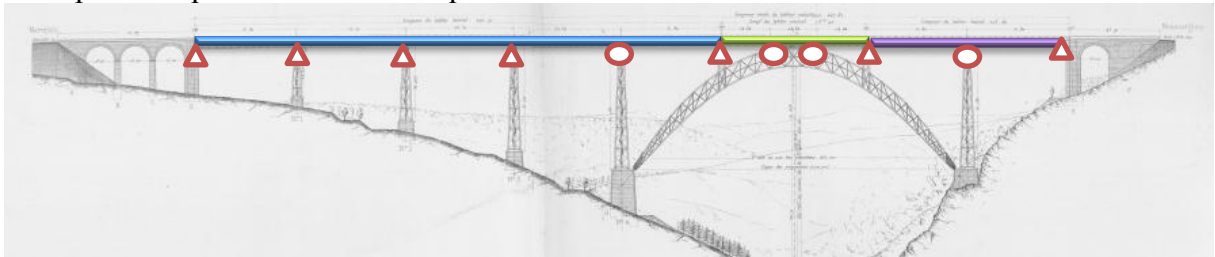
Figure 1 : Modélisation des appuis du tablier
