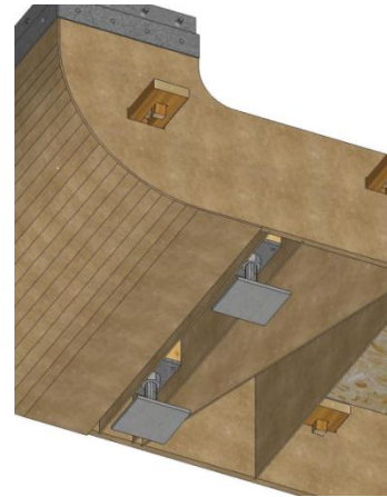
Figure 6 : Vue de dessous d'un module et détail d'un pied
