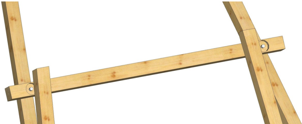
Fig. 18 : Détail boulonnage arches
